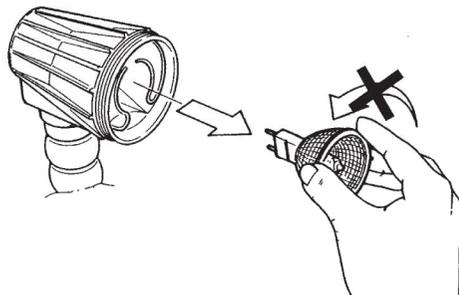
**Ersetzen der Halogenlampe**
